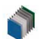
Laminacija filtera po DIN 18820 standardu. Hemijska zaštita izrađena od kombinacije odgovarajućih smola, C-stakla i staklenih vlakana.
